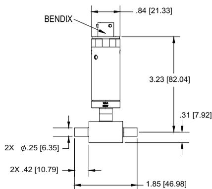
TUBE STUB/TUBE STUB
